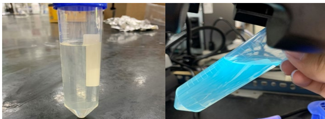
圖 10 實驗室製備石墨烯量子點溶液及在 365 nm UV 光下之螢光呈色
