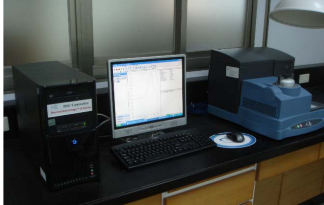
圖 3 TA Q20 微差掃描熱卡計
