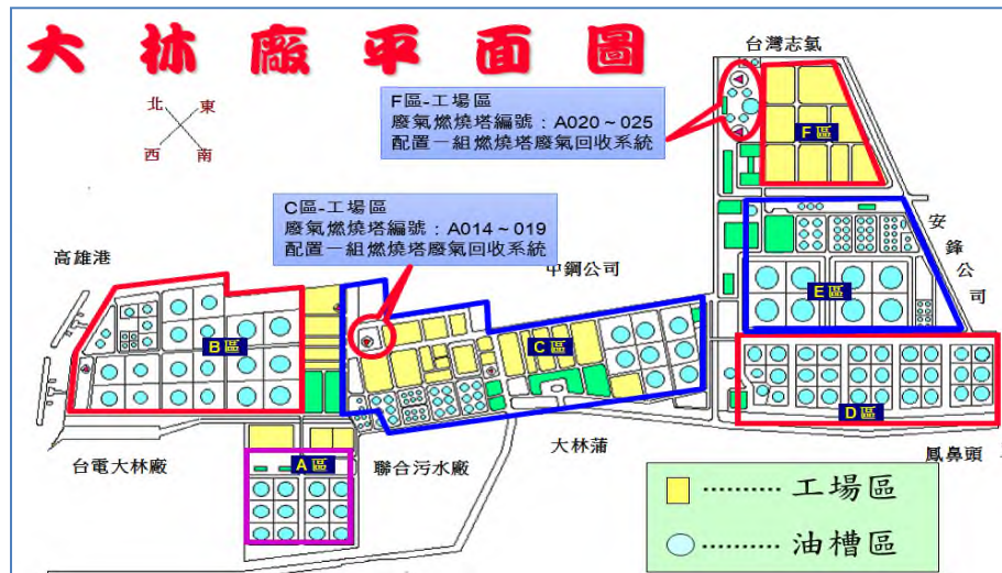
圖 1 大林廠燃燒塔與廢氣回收系統配置
